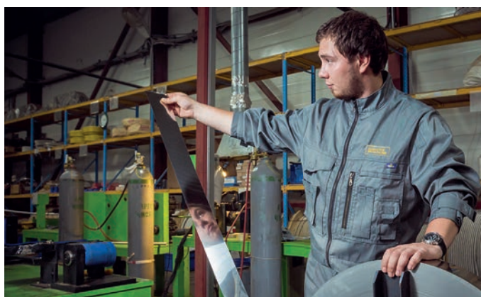
Лента из нержавеющей стали SS304 для производства гофрированной трубы
